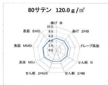
風合い計測（KES 法） ユニチカガーメンテックリサーチラボにて計測
