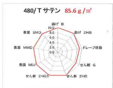
風合い計測（KES 法） ユニチカガーメンテックリサーチラボにて計測
